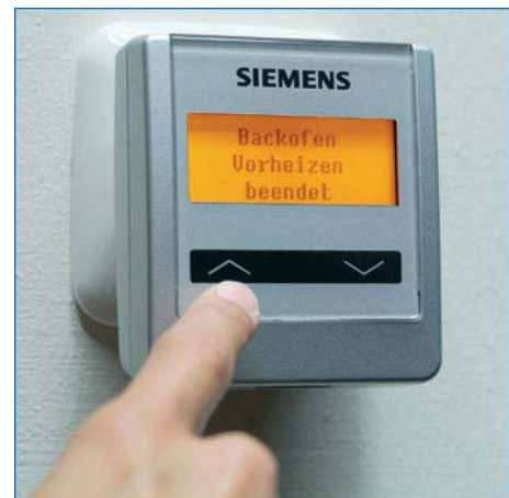
Abb. 23: System mit vernetzten Haushaltsgeräten mit integriertem Kommunikationsmodul
