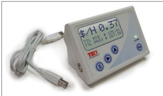
Abb. 13: Visualisierungsgerät TED – The Energy Detective der Florida Light and Power Company
