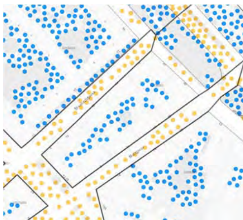
Abbildung 34: Kartendarstellung der Bohrlöcher (Lage aufgrund des Datenschutzes verändert), die im Häuserblock Miesbachgasse/Ob. Augartenstraße/Malzgasse/Leopoldsgasse gesetzt werden könnten
